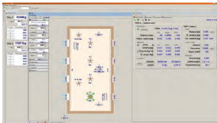
Ryc. 3. System WGJ-SILO można zintegrować w oprogramowaniu komputerowym FERMA obok regulatorów VIRGO, VIRGO-INL, systemu ważenia drobiu WGJ-8 i tak jak w przypadku tych urządzeń łączyć się z nim przez Internet
