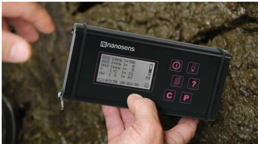
Fot. 1. Pomiar gazów w oborze Stanisława Popielarczyka. Poziom amoniaku przy ruszcie nie przekracza 5 ppm
