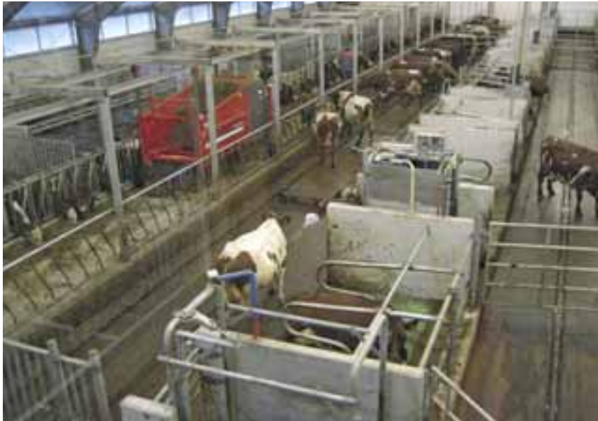
Fot. 7. Skandynawska obora gdzie stół paszowy uzupełniono o konstrukcję dla robota do zadawania paszy
