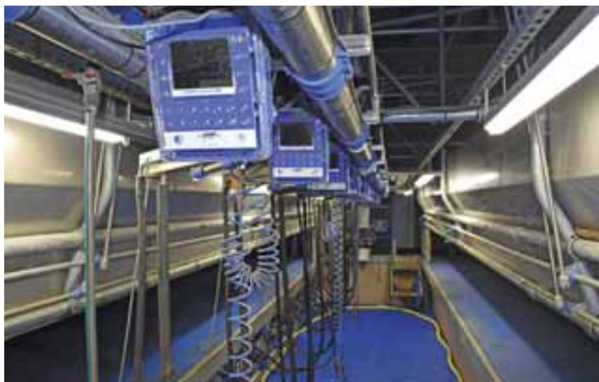
Fot. 9. System dojenia, zgodny z naturą, czyli wysokie podciśnienie w trakcie fazy wypuszczania mleka i bardzo niskie w trakcie fazy spoczynku, czyli zamknięcia strzyka
