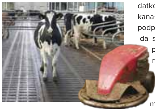
Fot. 2. Podłogi rusztowe ułatwiają utrzymanie czystości z wykorzystaniem np. samojezdnych robotów (fot. andersbeton.com)
