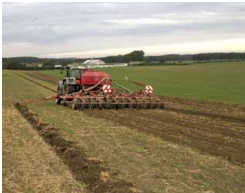
Fot. 2. Agregat nawozowo-siewny (fot. B. Skorupa)
