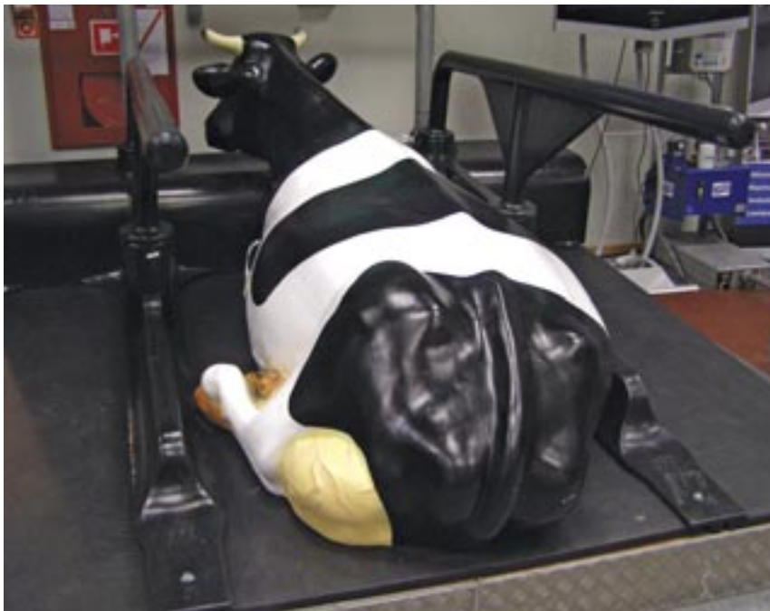
Fot. 2. Elastyczna przegroda z pojedynczą rurą w układzie poziomym
