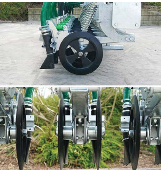
Fot. 1. Aplikator Solodisc XXL firmy Joskin ma samoopstrzające tancerze o średnicy 400 mm i grubości 20 mm, montowane na piastach o szczelnych, stożkowych łożyskach. Tworzą one bruzdy (maks. 6 cm), a stożek wtryskujący precyzyjnie i równomiernie wprowadza do tych bruzd gnojowicę, w taki sposób, że nie opryskuje ona roślin i szybciej wsiąka w ziemię. Po przejściu tancerza i wprowadzeniu gnojowicy do bruzdy, zostaje ona przykryta w sposób naturalny wskutek osuwania się ziemi
