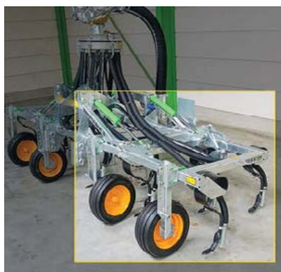
Fot. 2. Aplikator doglebowy Terraflex/3 . Kształt zębów zapewnia lepsze spulchnianie gleby dzięki wibracji, dobre mieszanie pozostałości roślin oraz dobre przygotowanie powierzchni gleby pod siew. Aplikacja gnojowicy odbywa się na ogół na głębokość 12-15 cm. Elastyczność sprężynowych zębów chroni aplikator przed niszczącymi przeszkodami. Idealny na grunty bez piasku i kamieniste oraz do intensywnego mieszania gleby z gnojowicą i słomą
