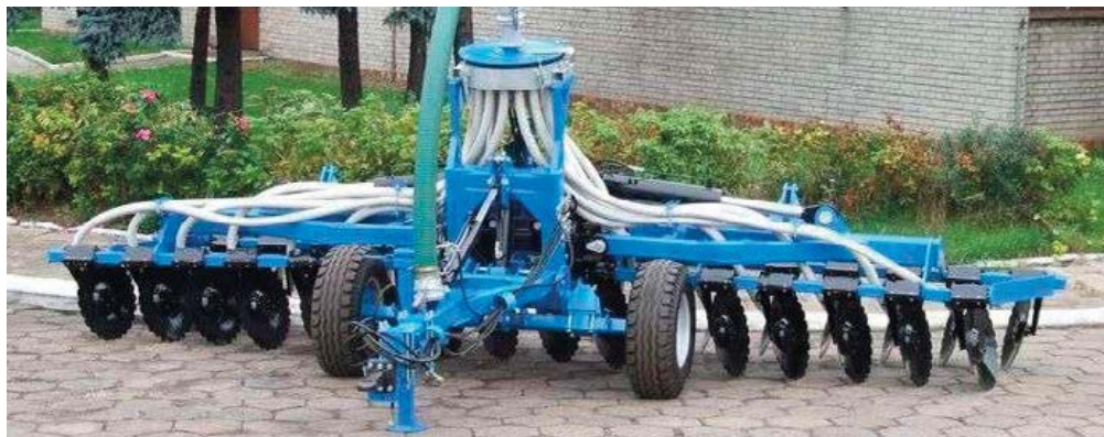
Fot. 4. Aplikatory doglebowe do wozów asenizacyjnych, w niedługim czasie wejdą na stałe jako podstawowy element wyposażenia chroniący środowisko naturalne przed nadmiernym uwalnianiem azotu, oraz gazów i zapachów do atmosfery
