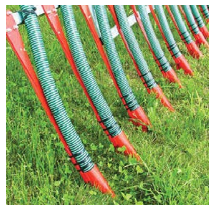
Fot. 3. Redlicowy aplikator do gnojowicy ZUNHAMMER przeznaczony do aplikowania gnojowicy na nieużytki i grunty orne. Gnojowica jest aplikowana do bruzd utworzonych przez zęby redlic, a następnie przysypywana ziemią. Aplikatory redlicowe mieszają glebę i nawóz płynny, dzięki czemu znacznie ogranicza się straty azotu
