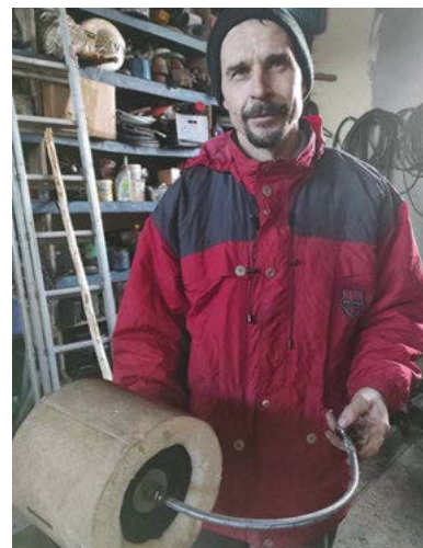
Fot. 11. W środku musi być wyjście wody, czyli zaworek i wężyk elastyczny podkręca do poidelka
