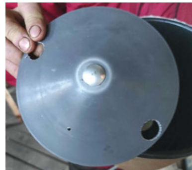
Fot. 9. Część poidła, na którą naciskają krowy, czyli „daszek” hodowca wykonał z szarego wywietrznika
