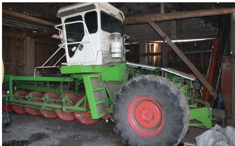
Fot. 6. Bazą do samojezdnej zgrabiarki była nieużywana sieczkarnia Claas Jaguar 80 SF; w 2022 r. sieczkarnia w parze z prasą zebrała ok. 1300 bel
