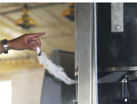
Fot. 9. Świeca dymna ułatwia pokazanie przepływów powietrza wentylowanego
