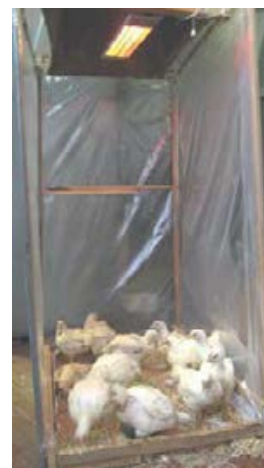
Rys. 4. Schemat (a) i zdjęcie (b) stanowiska doświadczalnego do badania parametrów termicznych w strefie technologicznej odchowalnika
