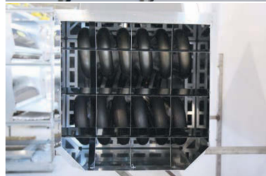
Nagrzewnica HOLLAND HEATER serii LTU gotowa do pracy (u góry) i otwarta do prezentacji
