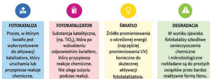
Rys. 2. Czynniki determinujące skuteczność procesu fotokatalizy
