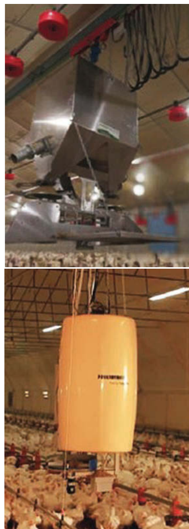
Rys. 2. Rozkładanie ściółki w kurniku z wykorzystaniem platformy na suficie: a) FirstPellets 2023, b) Poultry Mate 2023
