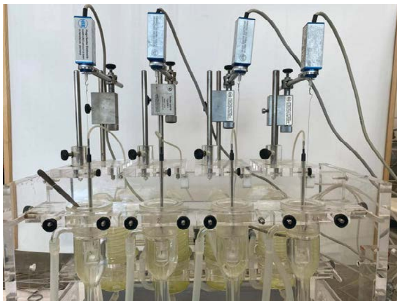
Ryc. 2. Łaźnia do badania izolowanych narządów, na zdjęciu widoczne 4 oddzielne komory otoczone płaszczem wodnym w celu utrzymania temperatury
