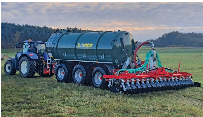
Wóz 25 000 litrów z agregatem tarczowym
