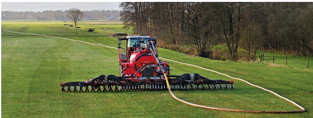
System aplikacji gnojowicy na tereny trawiaste za pomocą aplikatora z węzłem ciągnionym
