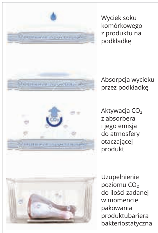
Rys. 1. Zasada działania podkładek MEGA CO 2 firmy Pomona COMPANY Ltd. Sp. z o.o.
