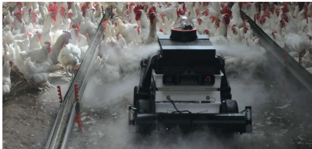
Fot. 3. Robot, który będzie zbierał dane środowiskowe dotyczące temperatury, wilgotności, dwutlenku węgla i natężenia światła
