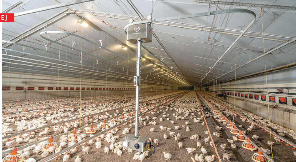
Fot. 4. Robot sufitowy do skanowania produkcji i otoczenia kurników, wyposażony w kamery umożliwiające monitorowanie ptaków pod kątem analizy zdrowia i dobrostanu
