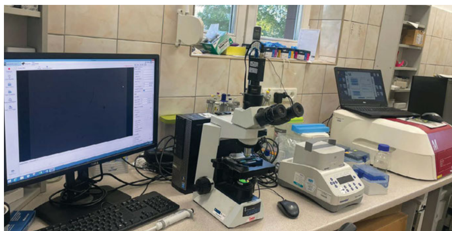
Rys. 3. Aparatura badawcza służąca do oceny jakości nasienia ptaków wykorzystywana przez naukowców z Instytutu Rozrodu Zwierząt i Badań Żywności PAN w Olsztynie. Od lewej: system do oceny ruchliwości plemników oraz cytometr przepływowy do oceny stanu funkcjonalnego plemników
